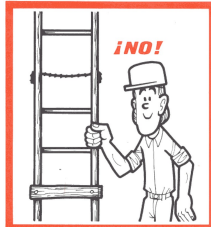
SOLO DEBEN USARSE ESCALERAS EN BUEN ESTADO.
