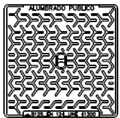
MARCOS Y TAPAS C250 (25Tm de carga)
