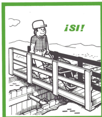
LAS ESCALERAS NO DEBEN UTILIZARSE COMO MONTANTES DE ANDAMIO, PISO DE TRABAJO O PASARELA.
