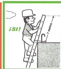
HACER TRASPASAR LAS ESCALERAS POR LO MENOS UN METRO POR ENCIMA DEL PISO DE TRABAJO AL QUE DAN PASO
