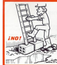
INSTALAR LAS ESCALERAS SOBRE UN SUELO ESTABLE, CONTRA UNA SUPERFICIE SÓLIDA Y FIJA Y DE FORMA QUE NO PUEDAN RESBALAR, NI BASCULAR.
