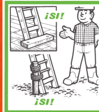
INSTALAR LAS ESCALERAS SOBRE UN SUELO ESTABLE, CONTRA UNA SUPERFICIE SÓLIDA Y FIJA Y DE FORMA QUE NO PUEDAN RESBALAR, NI BASCULAR.
