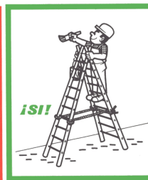
IMPEDIR QUE LAS ESCALERAS DOBLES SE DESLICEN, POR MEDIO DE CADENILLAS O CUERDAS. NO USAR NUNCA EL ÚLTIMO PELDAÑO.
