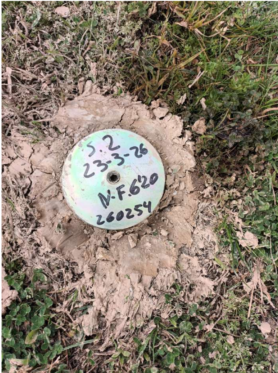
Tapa de tubería piezométrica sondeo 2bis.
