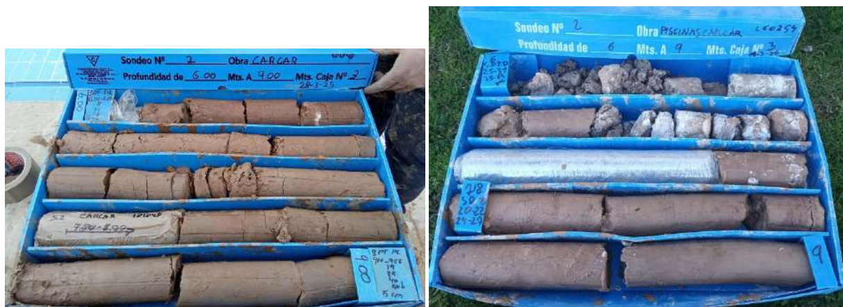
Ilustración 9: Aspecto de las arcillas con yesos del terciario en testigo de sondeo.
