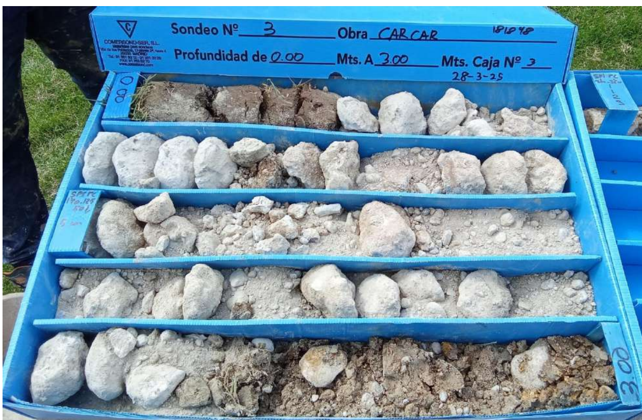
Ilustración 7: Rellenos de hormigón ciclópeo vertido en el sondeo 3. Rellenos de bolos y tierra a partir de los 2,5 metros.
