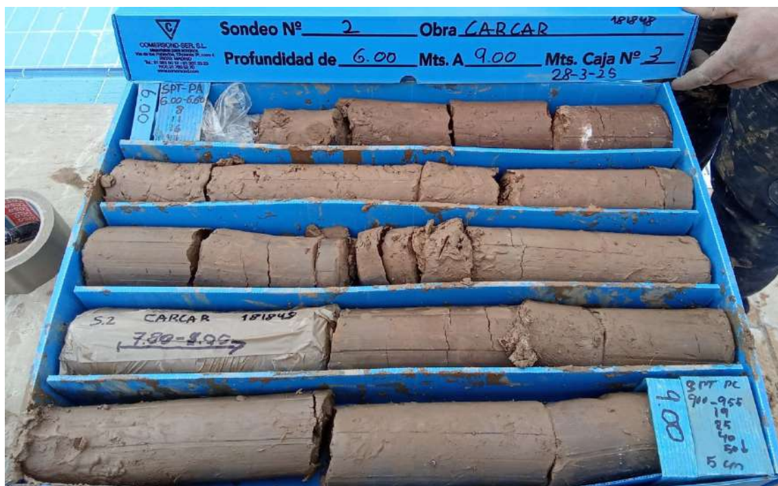
Sondeo 2, de 6 a 9 m.
