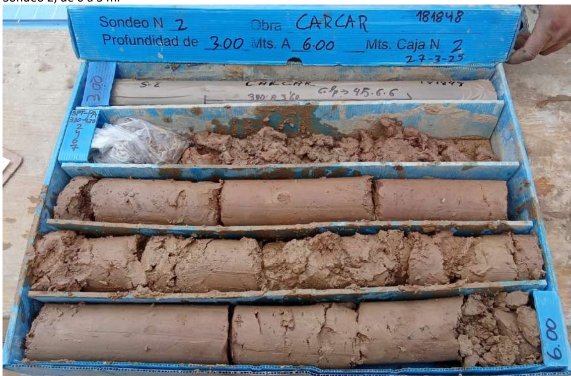
Sondeo 2, de 3 a 6 m.
