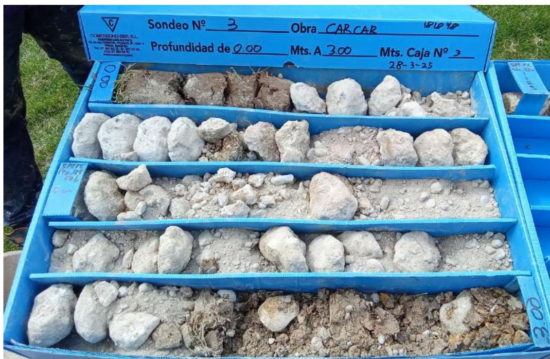
Sondeo 3, de 0 a 3 m.
