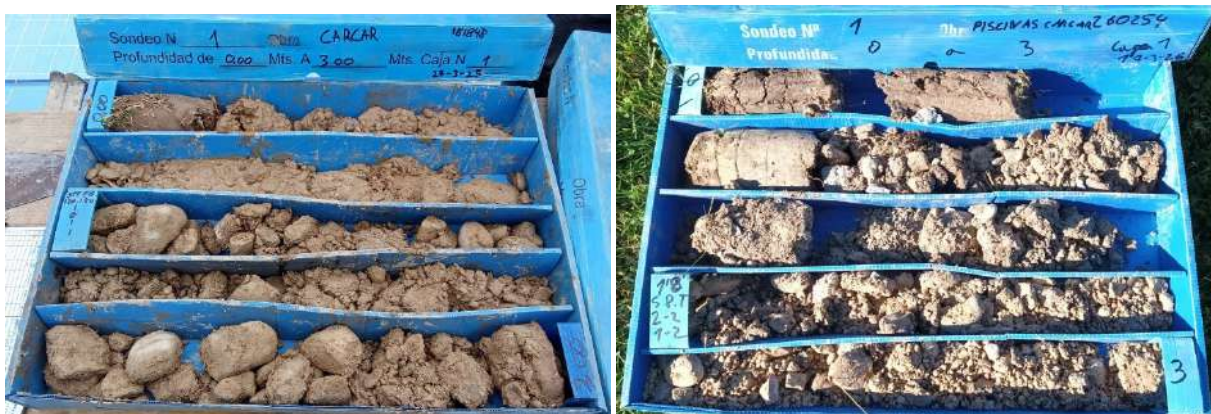
Ilustración 6: Rellenos de bolos en una matriz fangosa, compacidad muy suelta a suelta.
