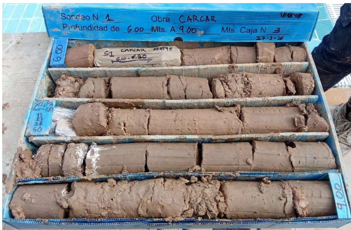
Sondeo 1, de 6 a 9 m.
