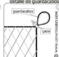
detalle de guardacabos
