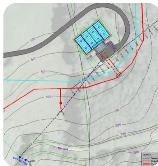
Fig 4.11 Nudo E/S depósito y Desagüe
