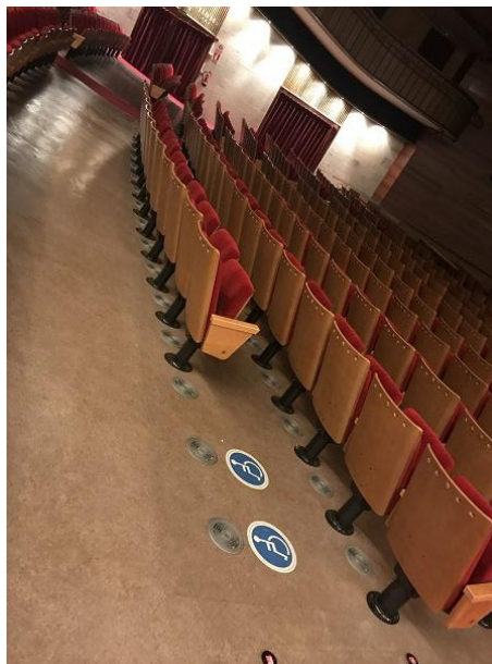
Ejemplo de espacio reservado para PMR con señalización
