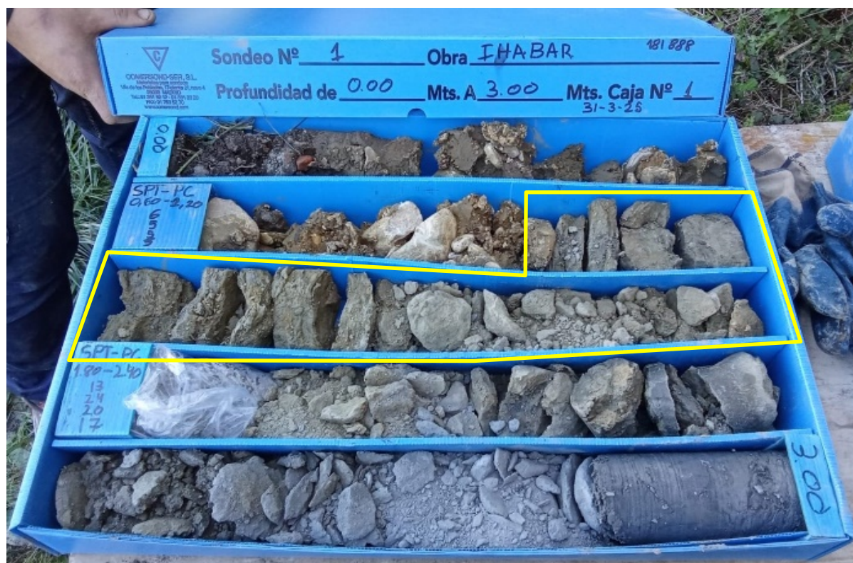
Ilustración 11: Aspecto de las arcillas blandas del coluvial/eluvial, UG 2.
