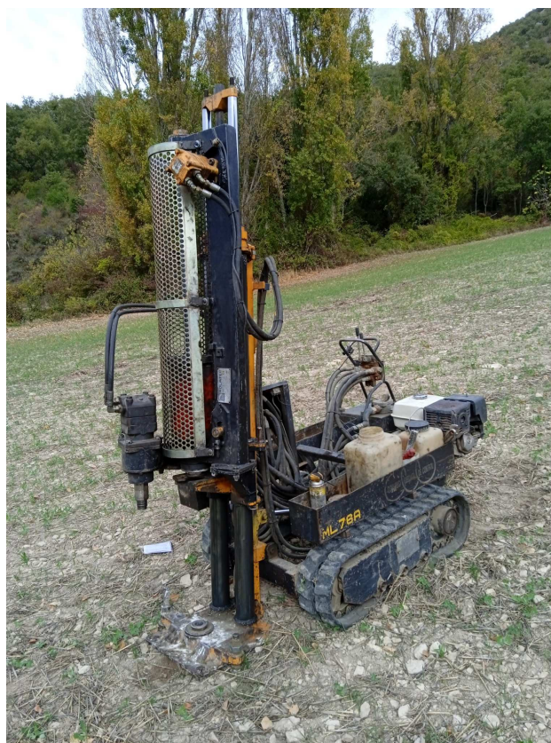
Ensayo de penetración DPSH P2
