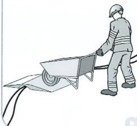
protección de conductores
