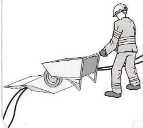
protección de conductores
