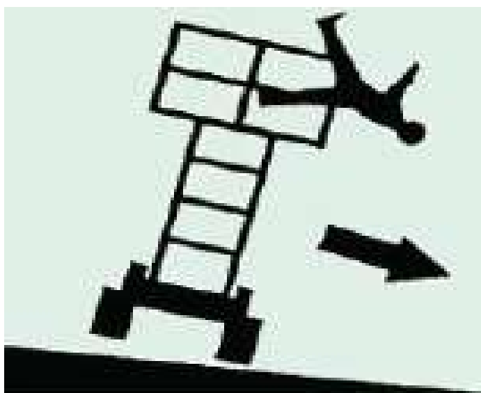
Vuelco de equipo por falta de estabilidad
