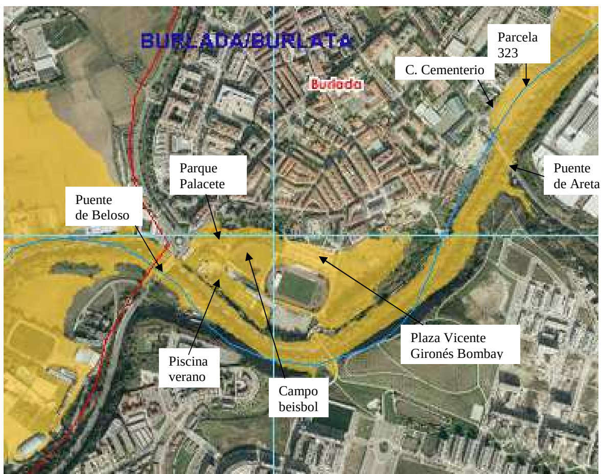
Figura 18: Desbordamiento del cauce en la sección crítica del puente de Beloso. (Figura correspondiente al periodo de retorno T = 100 años tomada de la CHE).
