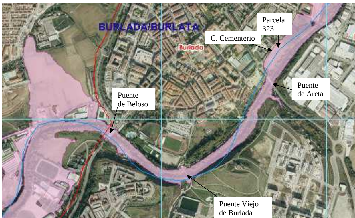
Figura 17: Circulación previa al desborde por el tramo comprendido entre el puente de Beloso y puente Viejo de Burlada. (Figura correspondiente al periodo de retorno T = 50 años tomada de la CHE).
