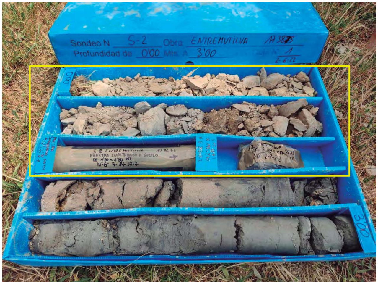
Ilustración 6: Aspecto de los rellenos en testigo de sondeo.
