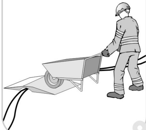
protección de conductores
