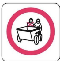
SP-240 PROHIBIDO TRANSPORTAR PERSONAS
