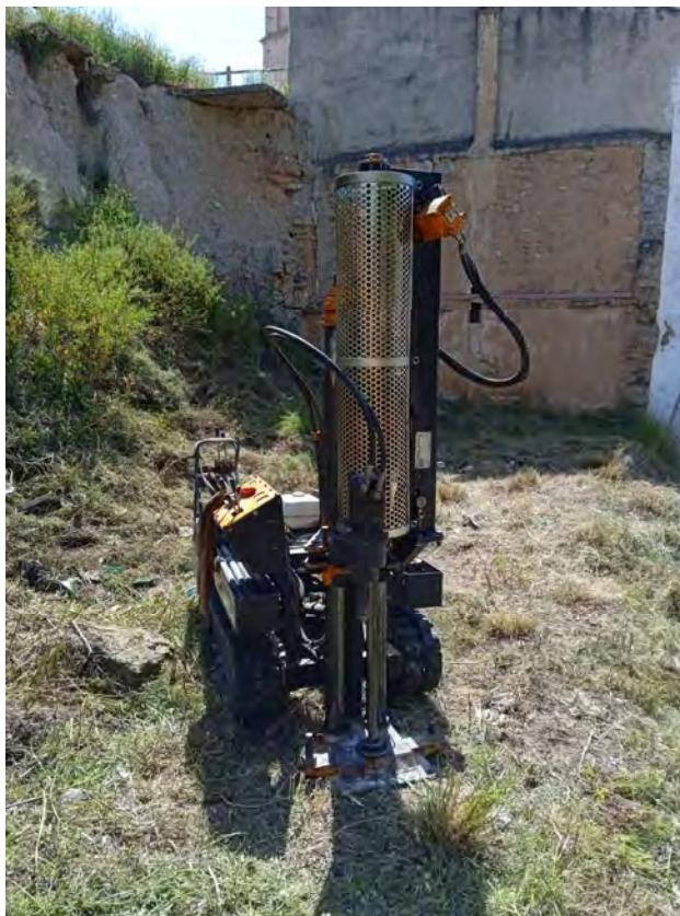
Ensayo de penetración dinámica P4.
