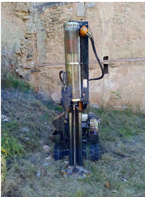
Ensayo de penetración dinámica P3.
