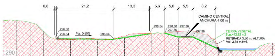
Detalle general de sección de retranqueo
