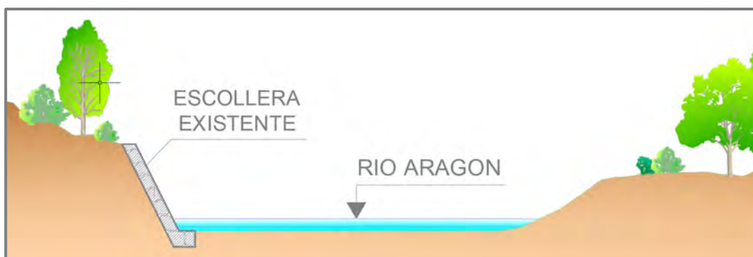
Estado y alcance actual del refuerzo de la margen izquierda
