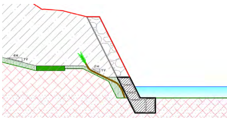
Sección tipo actuación rodal A. (Cobertura de ramas vivas)
