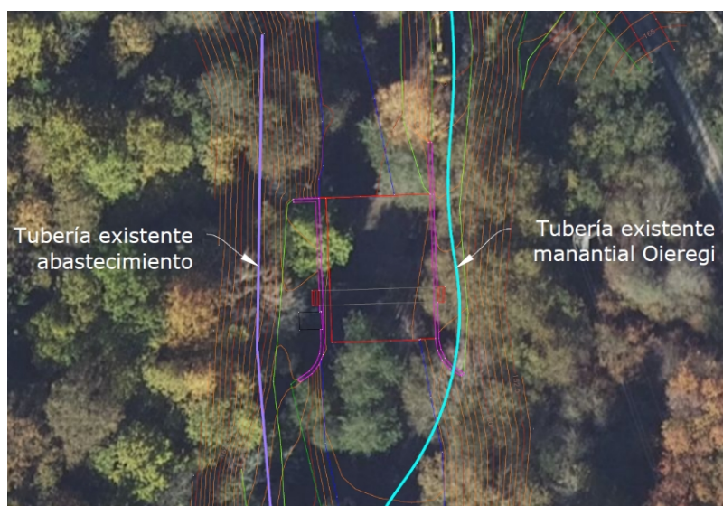
Imagen 3. Servicios afectados en la estación de aforo actual
