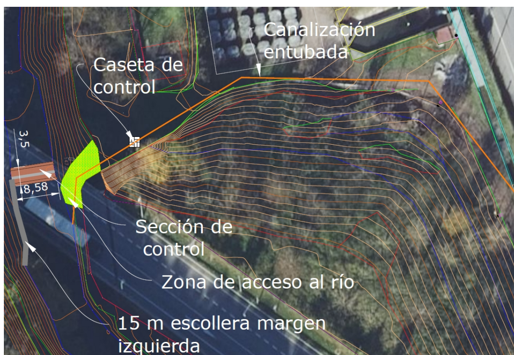
Imagen 1. Planta de la nueva estación de aforo
