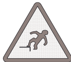
CAIDAS A DISTINTO NIVEL
