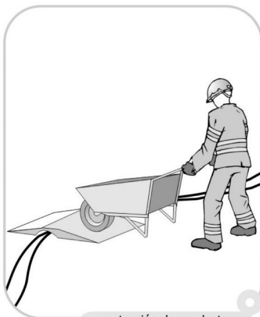
protección de conductores
