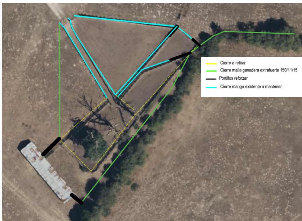
Imagen nº15: Trabajos a realizar en la manga de Mendingagusi.
