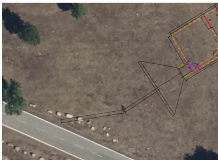
Imagen nº14: Tramos a realizar apertura de pista y afirmados.
