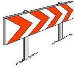
PANELES DIRECCIONALES PARA CURVAS
