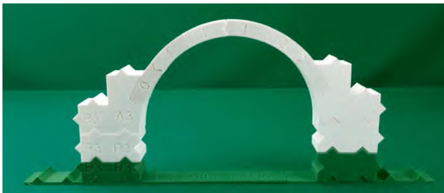
Descenso del apoyo izquierdo un 5% de su luz. El arco se mantiene estable, aunque aparecen grietas asimétricas. El descenso equivalente en el pórtico A4-5 de San Salvador sería de 54,8 cm .
