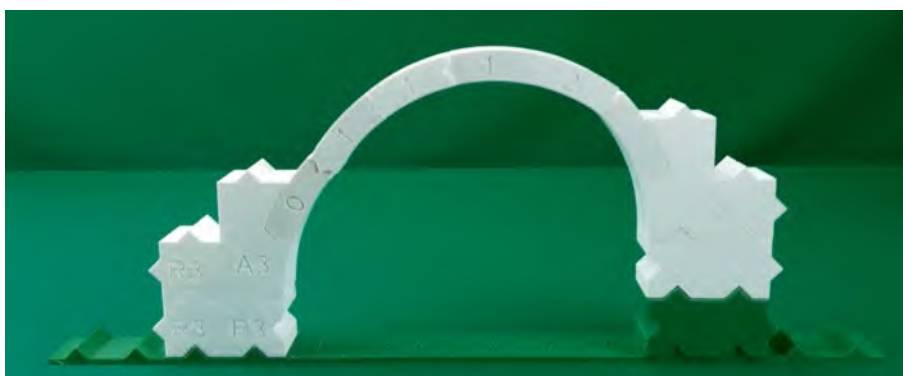
Descenso del apoyo izquierdo un 16% de su luz. El arco sigue sin caerse, trabaja como un arco asimétrico, del mismo modo que lo haría un arco de un tramo de escalera. El descenso equivalente en el pórtico A4-5 de San Salvador sería de 175 cm .
