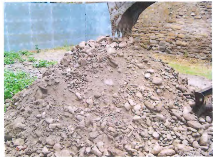
Fotografía 4: Gravas, limos, arcilla y arena de la calicata 4
