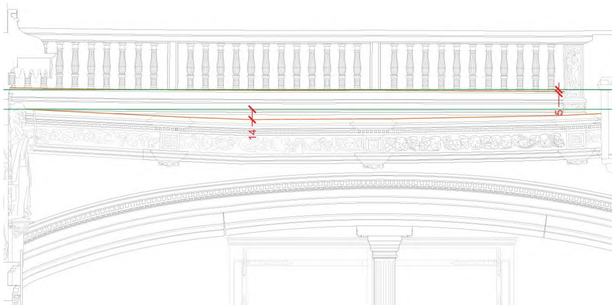
Plano de detalle del arco del coro con los desplazamientos verticales acotados
