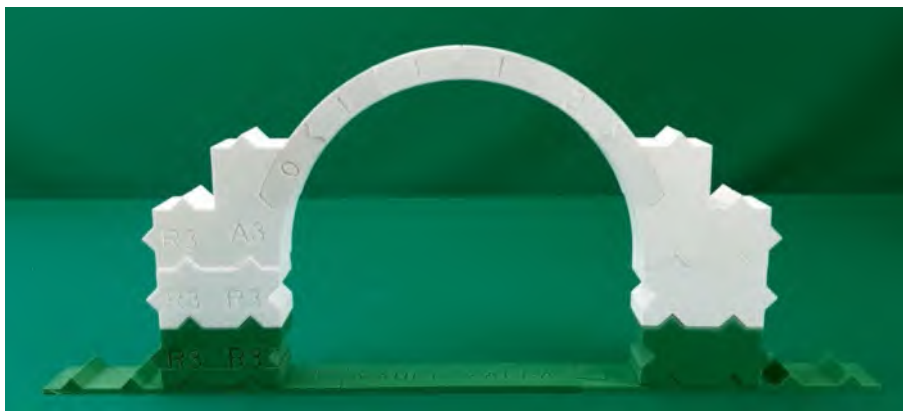
Estado inicial del pórtico con los dos apoyos a la misma altura.
