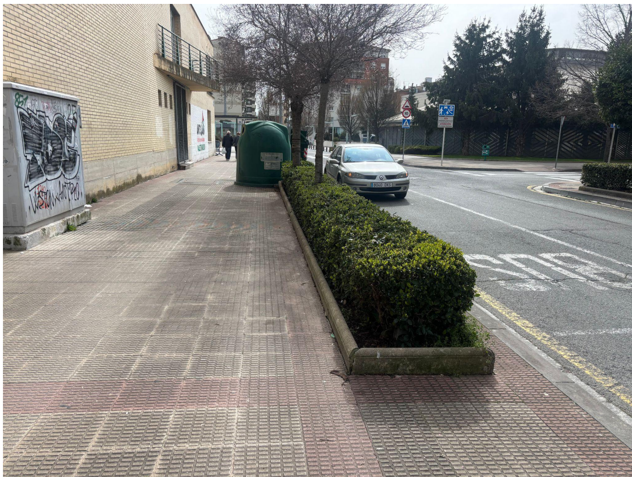
Setos y parada de autobús en Divina Pastora, mirando hacia Hermanos Noain. Una parte de estos setos puede eliminarse para mejorar la accesibilidad peatonal entre el autobús y la acera.
