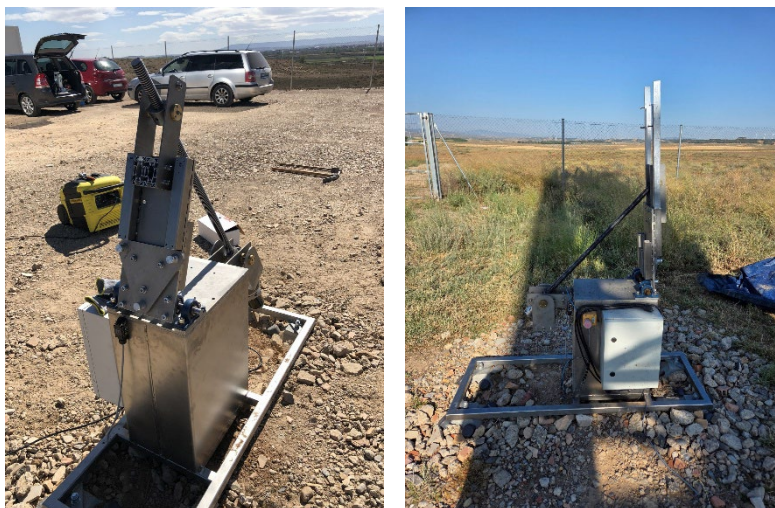
Figura 4. Mástil con sistema de izado actual
