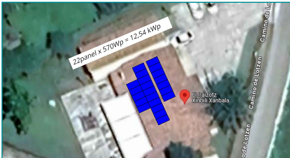
8. Imagen: Distribución de los paneles en la cubierta
