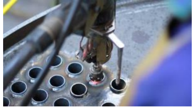
Soldadura automática de tubos de humos mediante robot de soldadura orbital
