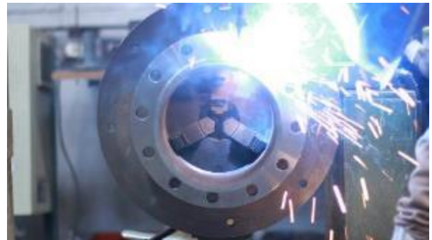
Soldadura de las conexiones (tubuladuras) mediante robot de hilo oscilante
