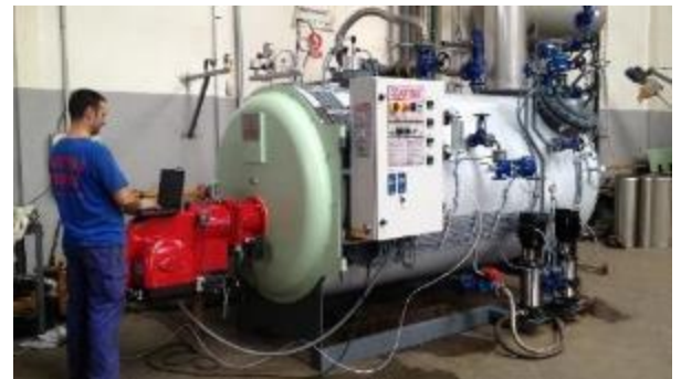
Pruebas de rendimiento y consumo de todas las calderas fabricadas.
