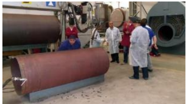
Soldadura cilíndrica y longitudinal automática mediante arco sumergido (libre de oxígeno)
