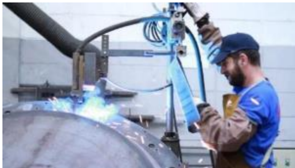
Soldadura de las tapas y accesorios de la caldera RL mediante robot de soldadura
