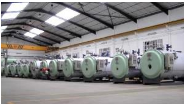
Producción en serie de la caldera de vapor ATTSU RL en nuestra fábrica en Celrà (Girona)
