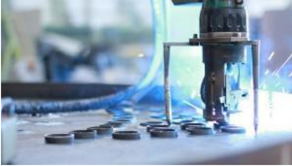
Soldadura automática de tubos de humos mediante robot de soldadura orbital
