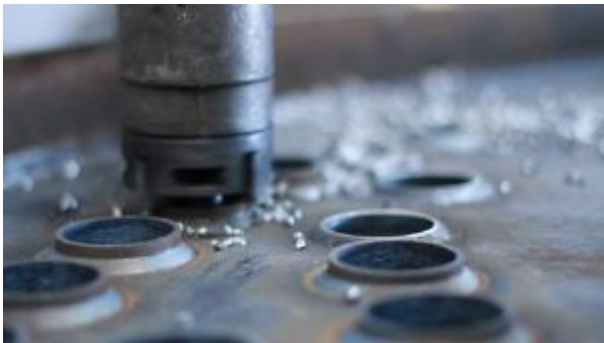
Refrendado automático de los tubos, garantizando una larga vida útil de los mismos.
