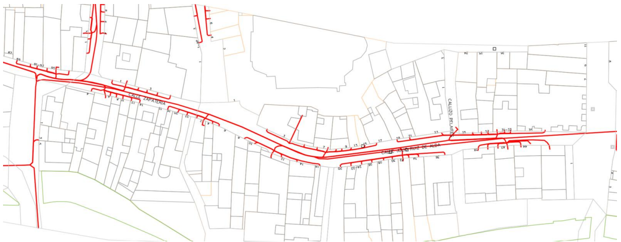
Imagen 5. Red de telecomunicaciones en montaje subterráneo
