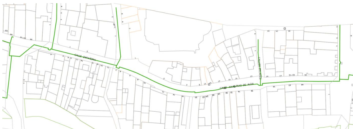
Imagen 7. Red de gas en montaje subterráneo
