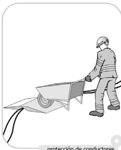
protección de conductores
