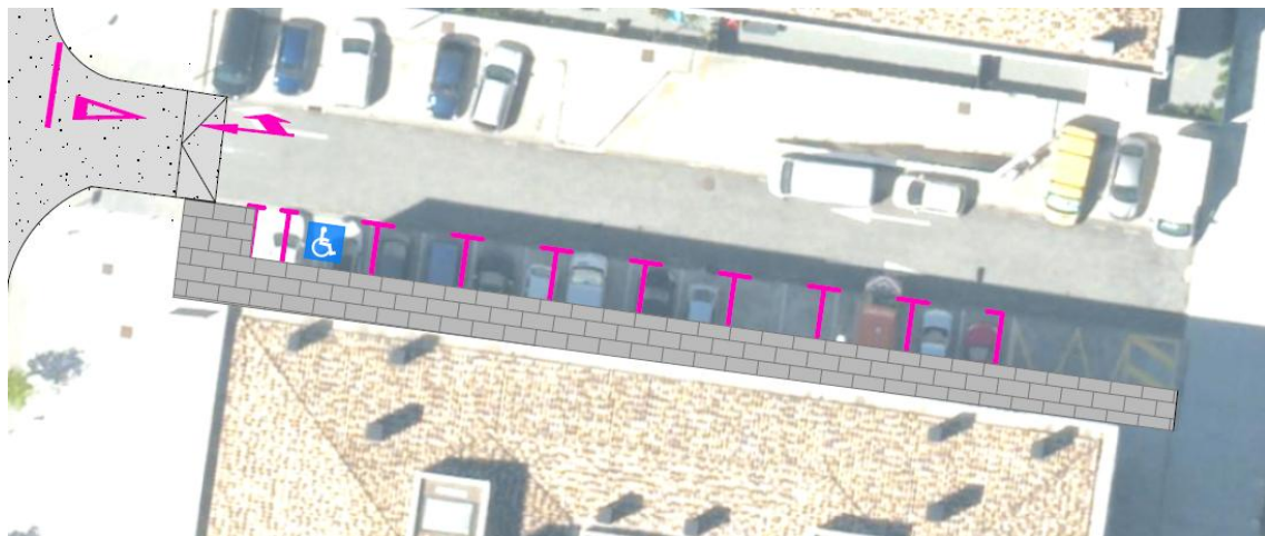
Figura 12. Ampliación de acera en calle Rafael Alberti.
