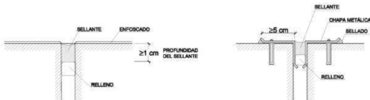
Figura 2.6 Ejemplos de juntas de dilatación
