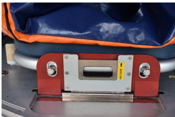
Sistema de anclaje de la camilla en la parte trasera.
