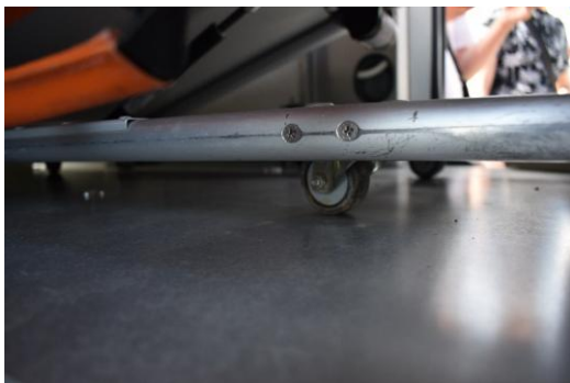
Sistema de deslizamiento de la camilla mediante ruedas
