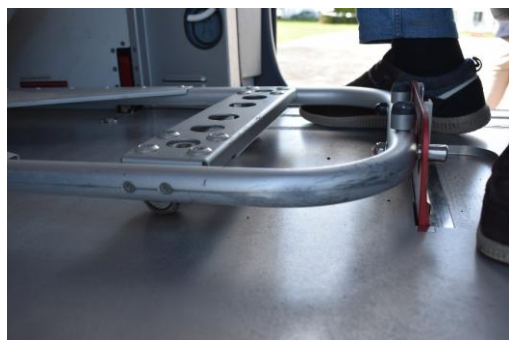
Sistema de anclaje de la camilla en la parte delantera.
