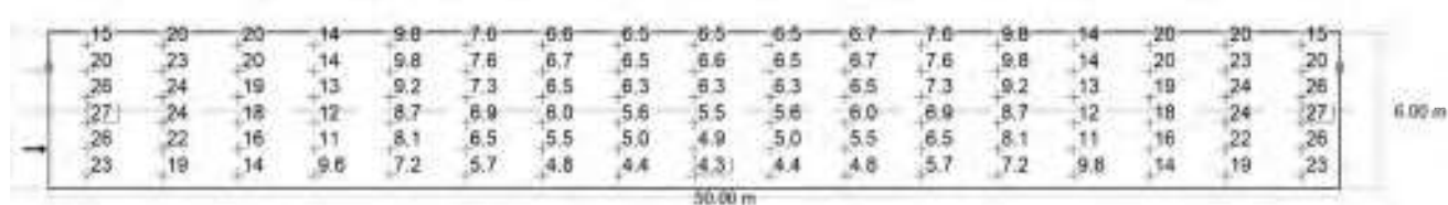
Valor de mantenimiento iluminancia horizontal [lx] (Sistema de valores)
