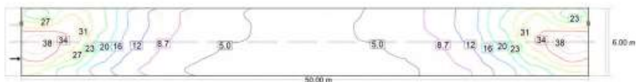
Valor de mantenimiento iluminancia horizontal [lx] (Líneas Isolux)
