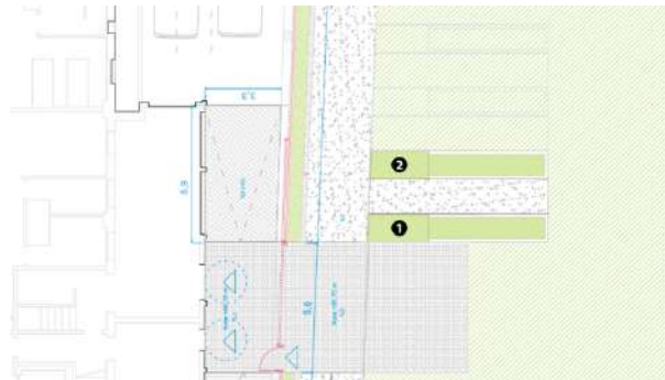
Obraen eraikiko dira. Elementu altuak, T formako hormigoi armatzuko oinarri hegaldua izango du gurpildun aulkientzako 75cm-ko hutsunea utziz; bere gainean 10cm-ko zurezko lorontzia kokatuko da. Elementu baxuak, hormigoi-blokeko perimetro izango du, enfoskatua. Altuera ezberdinetako lorontzi hauek lotuak egingo dira eta goikoaren urak, behekora jaitziko dira, ondoren guztiak modu jasagarrian parkeko zoruari bertan drenatuaz.
