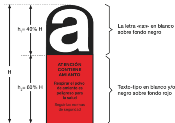
Etiqueta reglamentaria de identificación de materiales con amianto
