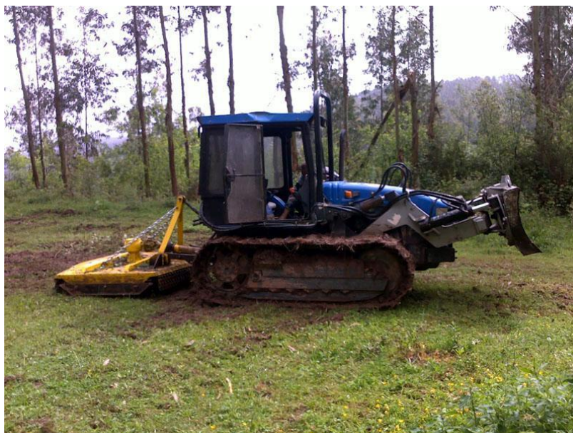
Tractor oruga con pala bulldozer y apero desbrozador en su bastidor trasero
