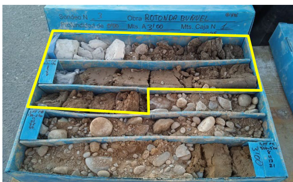
Ilustración 4: Aspecto del material de aportación, sondeo 3.
