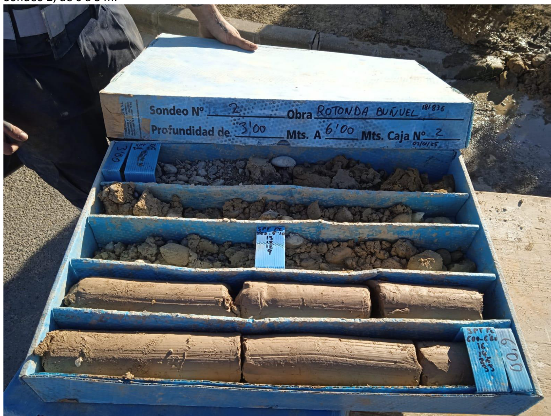
Sondeo 2, de 3 a 6 m.
