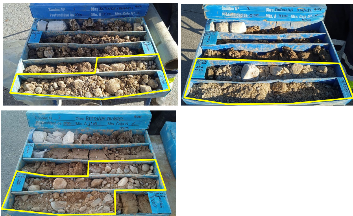
Ilustración 5: Aspecto de las gravas aluviales, UG 2, en los sondeos.
