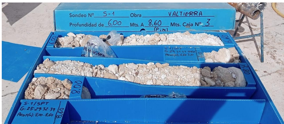
Sondeo 1, de 6 a 8 m.
