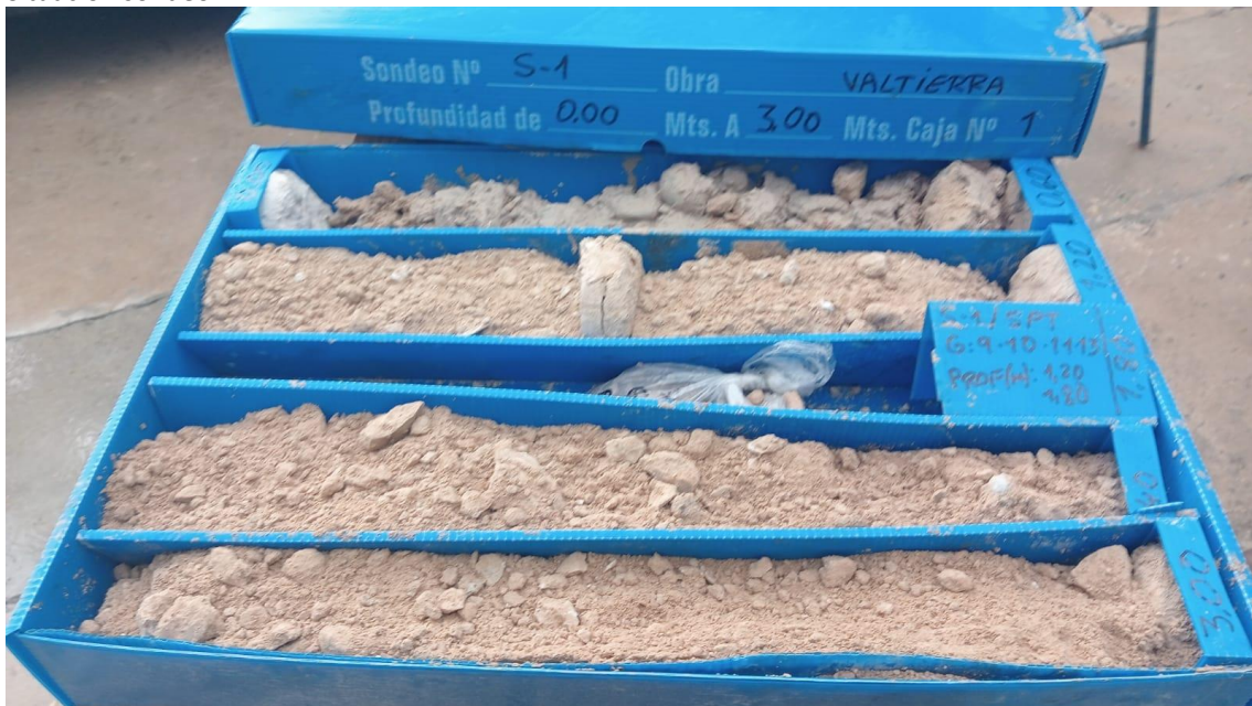
Sondeo 1, de 0 a 3 m.
