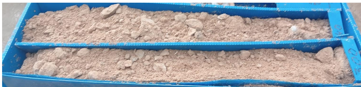
Ilustración 5: Aspecto de Los limos en testigo de sondeo.
