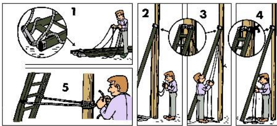
INMOVILIZACIÓN DE LA PARTE SUPERIOR DE UNA ESCALERA
