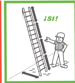
VIGILAR QUE LA SEPARACION DEL PIÉ DE ESCALERA, DE LA SUPERFICIE DE APOYO, SEA LA CORRECTA.
