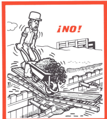
LAS ESCALERAS NO DEBEN UTILIZARSE COMO MONTANTES DE ANDAMIO, PISO DE TRABAJO O PASARELA.
