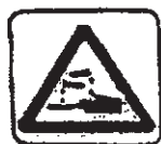
RIESGO DE CORROSION SUSTANCIAS CORROSIVAS
