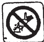
PROHIBIDO APAGAR CON AGUA
