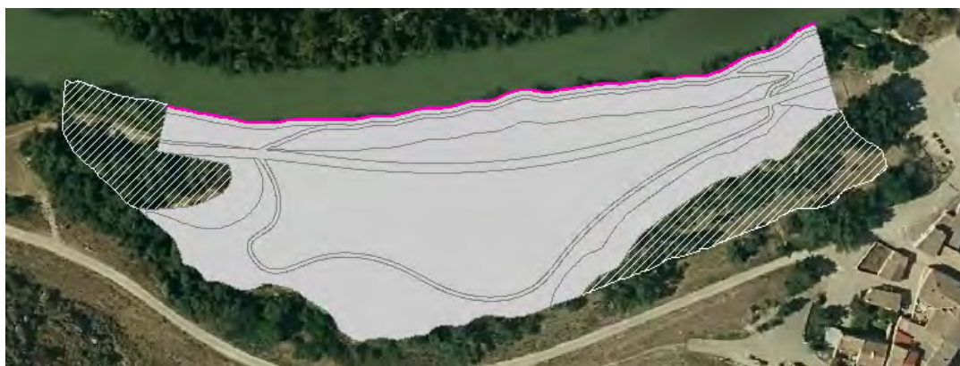
Localización del pie de escollera a mantener
