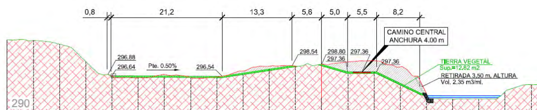
Detalle general de sección de retranqueo
