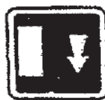
LOCALIZACION SALIDA DE SOCORRO
