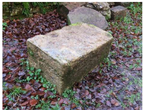
Izda.: Sillar correspondiente a una mocheta de un hueco de piedra roja de Baztán. Dcha.: Sillar de piedra dolomita.
