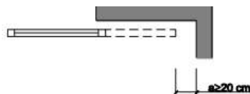
Figura 2.1 Holgura para evitar atrapamientos
