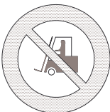
PROHIBIDO EL PASO A CARRETILLAS
