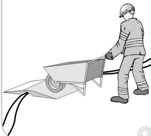
protección de conductores
