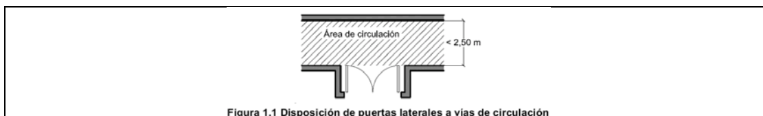
Figura 1.1 Disposición de puertas laterales a vías de circulación
