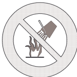
PROHIBIDO APAGAR CON AGUA
