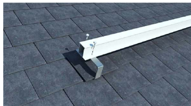
DETALLE INSTALACIÓN COPLANAR CUBIERTA TEJA MODULOS FOTOVOLTAICOS
