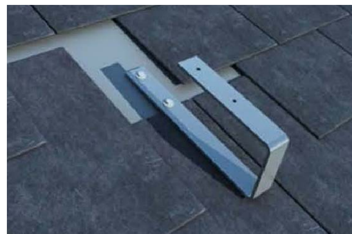
DETALLE INSTALACIÓN COPLANAR CUBIERTA TEJA MODULOS FOTOVOLTAICOS
