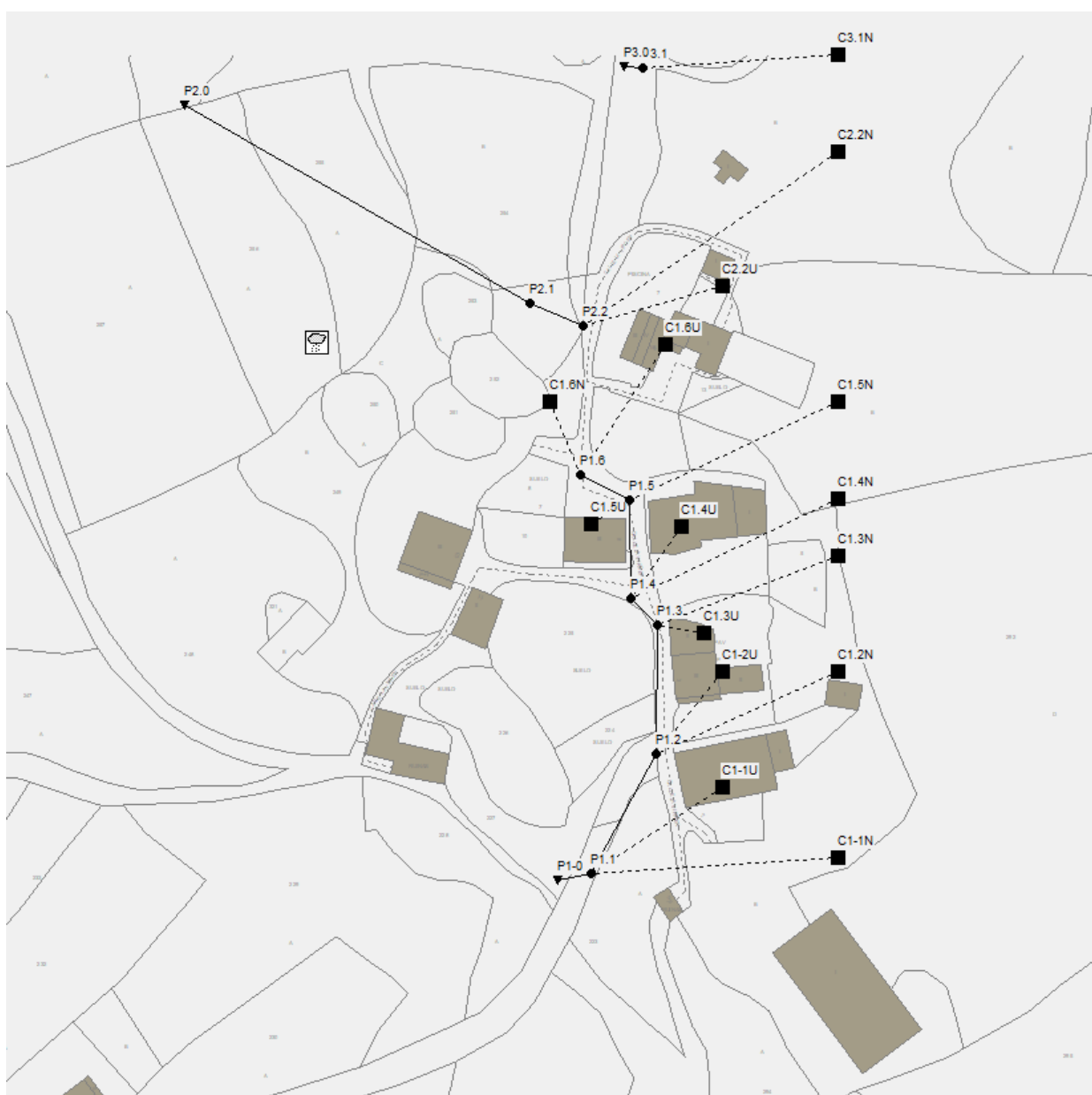
Imagen 1. Esquema general de la red de agua pluviales. Modelo SWMM
