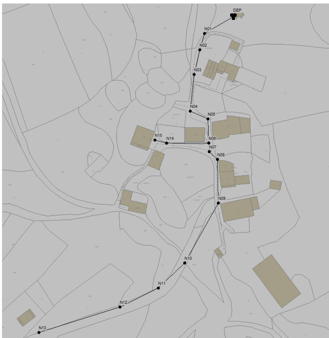
Imagen 4. Modelo matemático de la red de distribución de agua. Modelo EPANET
