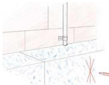
Detalle de la instalación de las planchas de aislamiento en la fachada cuando existen conducciones externas
